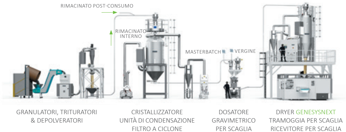
Esempio di impianto Piovan Group per il trattamento di materia prima riciclata.
