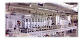
Das Entfeuchtungssystem besteht aus vier Modulen. (Bildquelle: Piovan)  ${\bf Q}$
